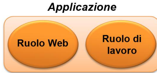
Figura 1: un'applicazione Windows Azure è costituita da uno o più ruoli, ad esempio dalla combinazione di un ruolo Web e di un ruolo di lavoro come in questo caso.
